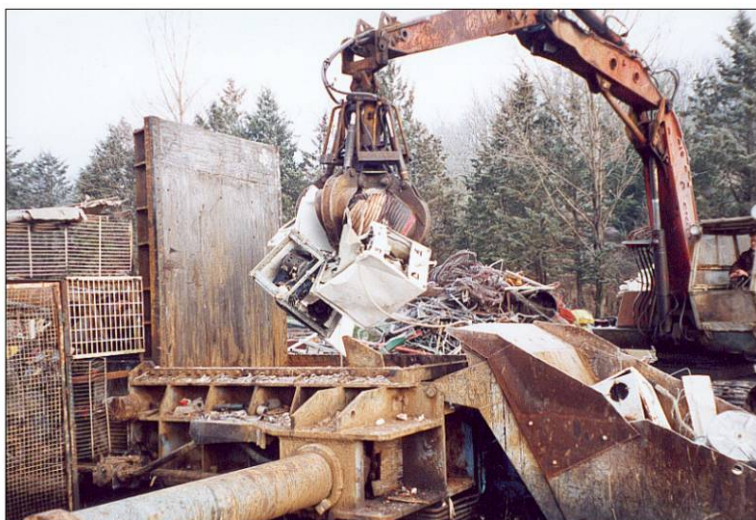
Chargement de la presse Source de bruit presse et pelle mécanique à grappin
