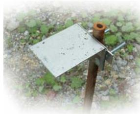
Pose de plaquettes et de jauges de mesure des retombées de poussières
